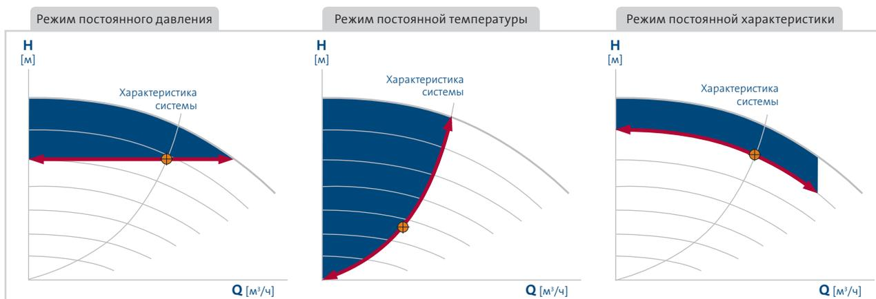
Режим постоянного давления используется в системах с переменным расходом с предельно малыми потерями давления, а также в системах, где потери давления в трубе зависят от статического напора.
