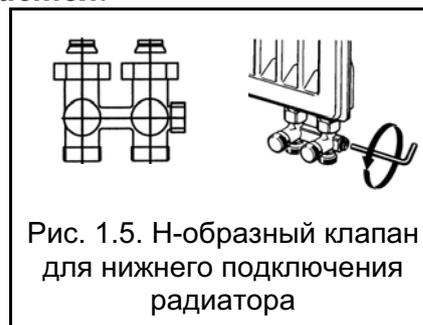
Рис. 1.5. Н-образный клапан для нижнего подключения радиатора
