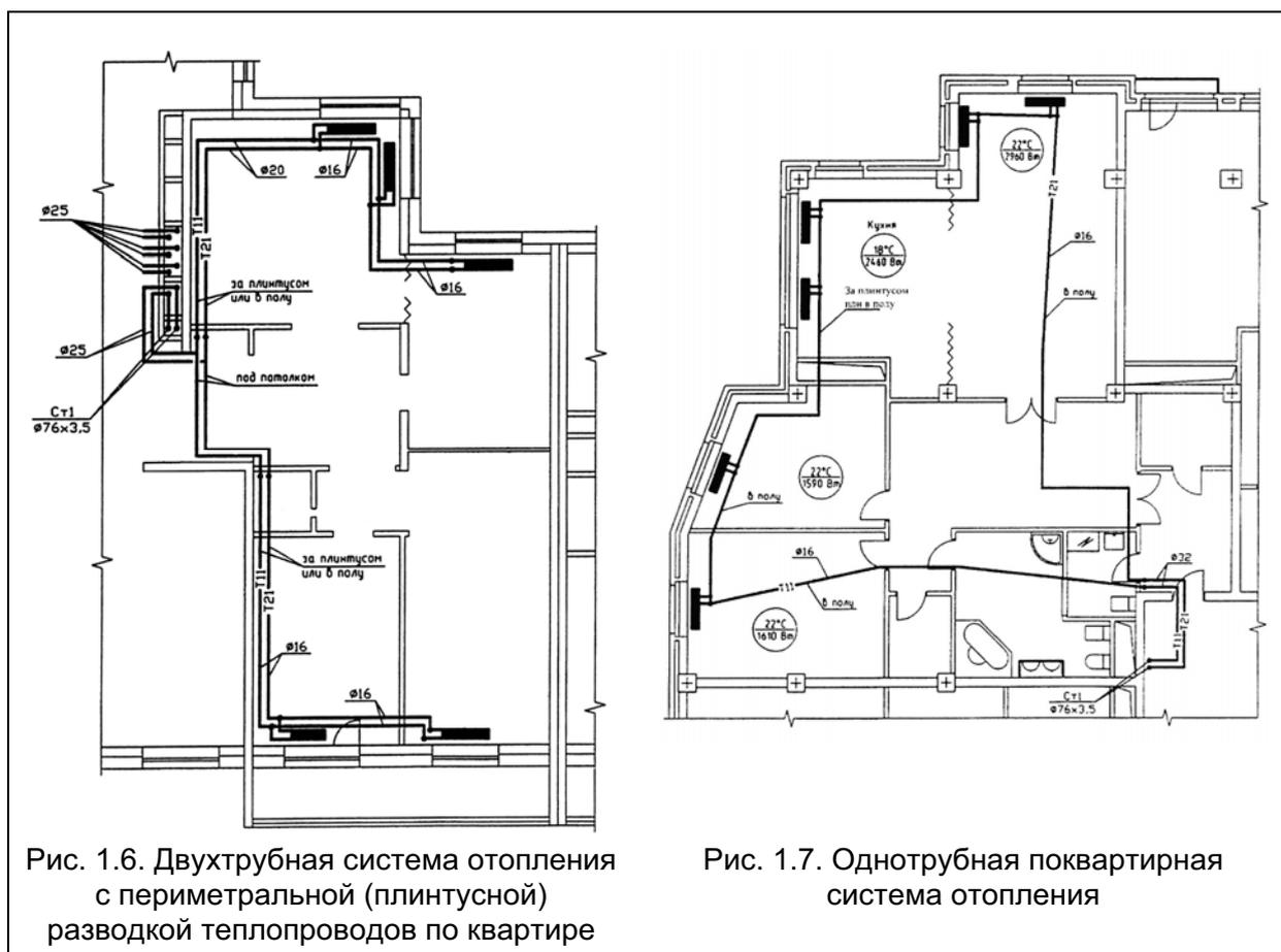
Рис. 1.6. Двухтрубная система отопления с периметральной (плинтусной) разводкой теплопроводов по квартире
