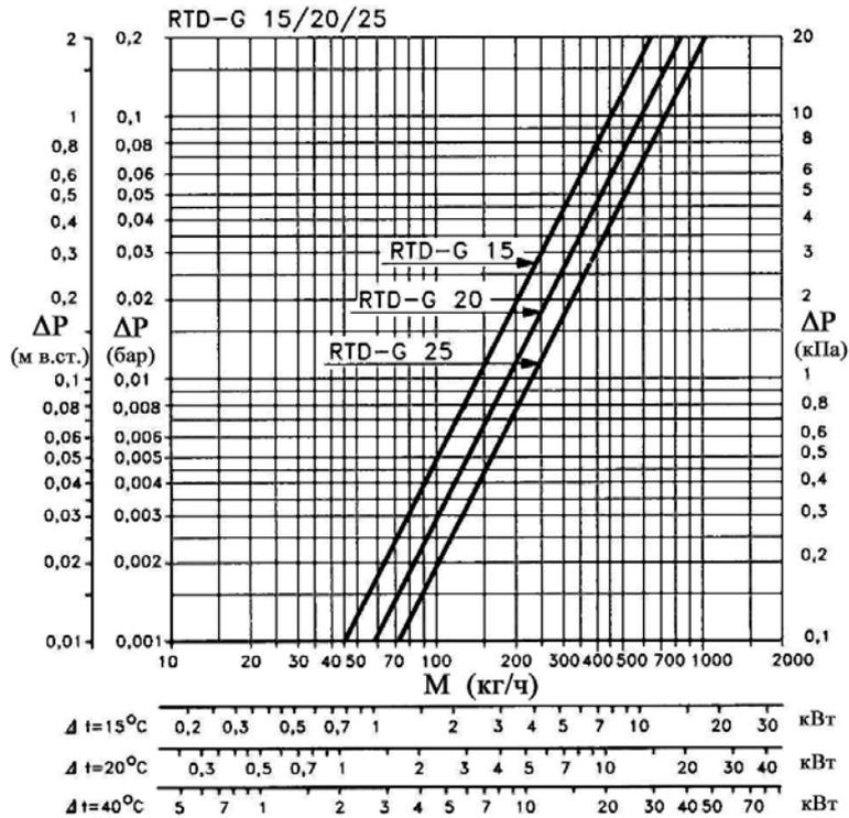
Рис. 2.2. Гидравлические характеристики термостатов «Данфосс»: а – **RTD-N 15** при различных уровнях монтажной настройки клапана для двухтрубных систем отопления с подводками  $d_y$  15 мм; б – **RTD-G** для гравитационных и насосных однострунных систем отопления с подводками  $d_y$  15, 20 и 25 мм (при настройке на режим 2К)
