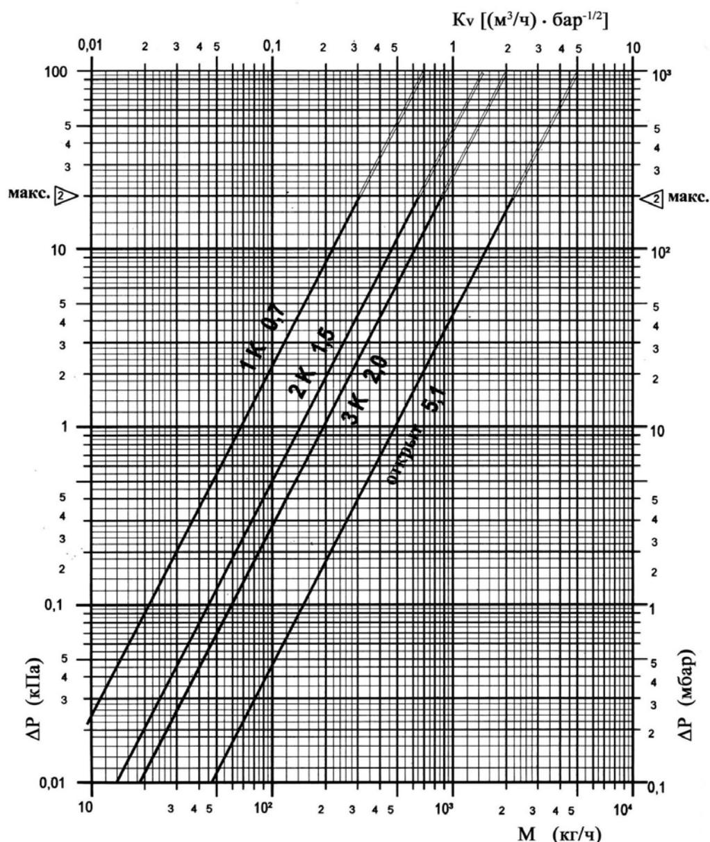
Рис. 2.5. Гидравлические характеристики термостатов «ГЕРЦ-TS-E» при различных режимах настройки
