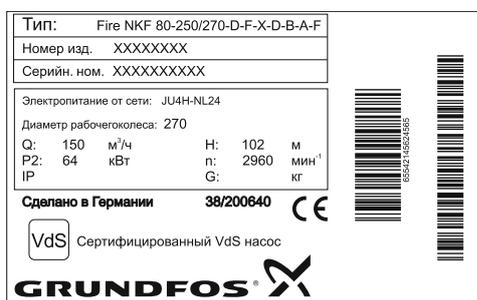
Рис. 10 Пример фирменной таблички насосной установки Fire NKF
