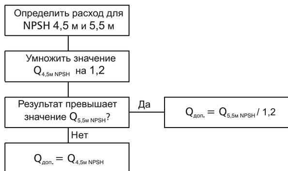
Рис. 4 Обозначение рассчитанного значения  $Q_{доп}$
