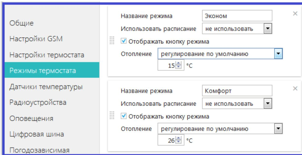
Управление будет выполняться по расчетной температуре теплоносителя, ограниченной сверху значением кривой ПЗА, оптимальной для поддержания в помещении заданной целевой температуры воздуха.
