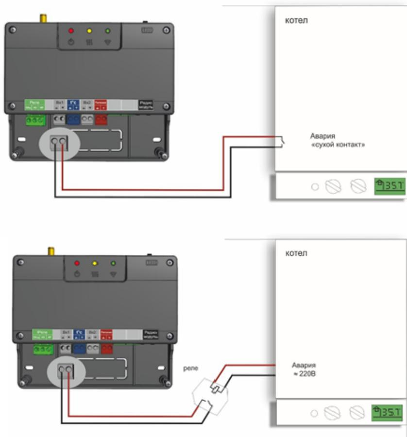
Чтобы Вход, к которому подключен сигнал «Авария котла», мог обрабатывать этот сигнал, в Настройках нужно обязательно указать тип сигнала для данного входа:
