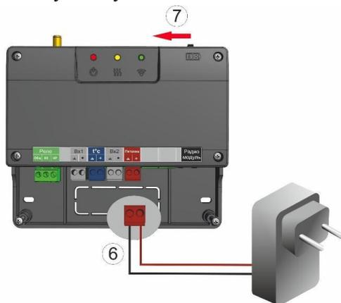
8. Установите контроллер на место использования, закрепите провода и установите лицевую панель
