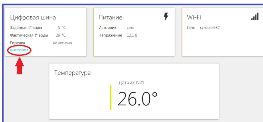
При цифровом управлении котлом в блоке «**ЦИФРОВАЯ ШИНА**» отображаются заданные и фактические значения штатных датчиков и технические параметры котла.
