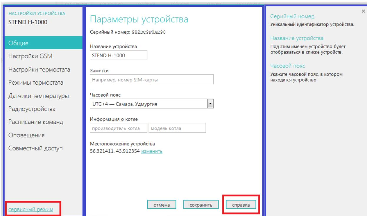
Кнопка «**Сервисный режим**» открывает доступ к сервисным настройкам термостата: управлению по цифровой шине, настройке режима ПЗА, назначению для контроля датчиков температуры и расширенной настройке Режимов работы термостата.
