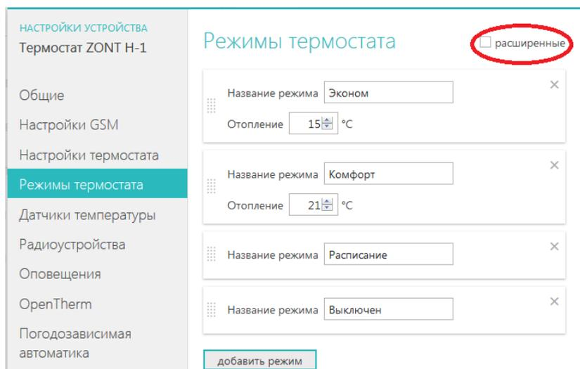
**Расширенный** – дополнительно позволяет настроить алгоритм работы контроллера в каждом режиме (назначить для управления другой датчик температуры, выбрать вариант полного отключения и т.п.).
