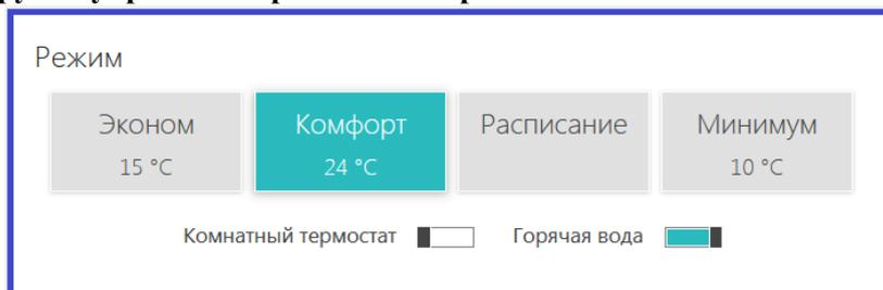
Предназначена для включения предустановленных режимов работы с заданными в них целевыми температурами. Действующий режим выделяется цветом.
