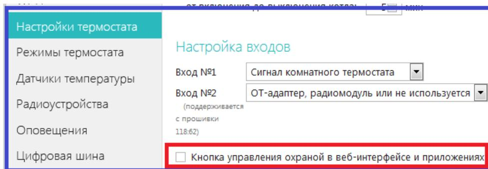
В настройке входов надо правильно выбрать тип подключаемых для контроля датчиков. Рекомендуемые схемы подключения разных типов и моделей датчиков доступны по ссылке «Схемы подключения датчиков»
