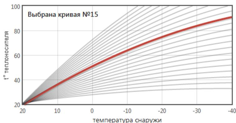
**Режим ПЗА** предназначен для управления работой котла с учетом изменения температуры на улице.
