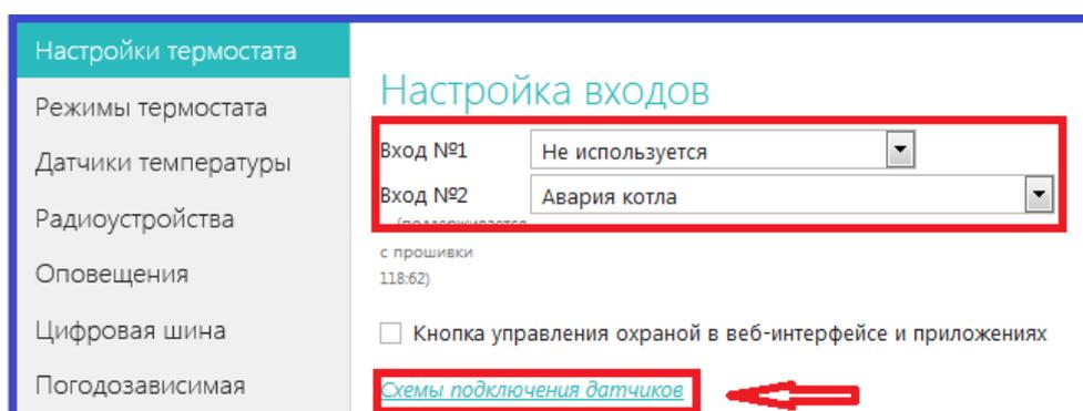
Настройка входа для правильной обработки сигнала от подключенного датчика выбирается из предлагаемого списка:
