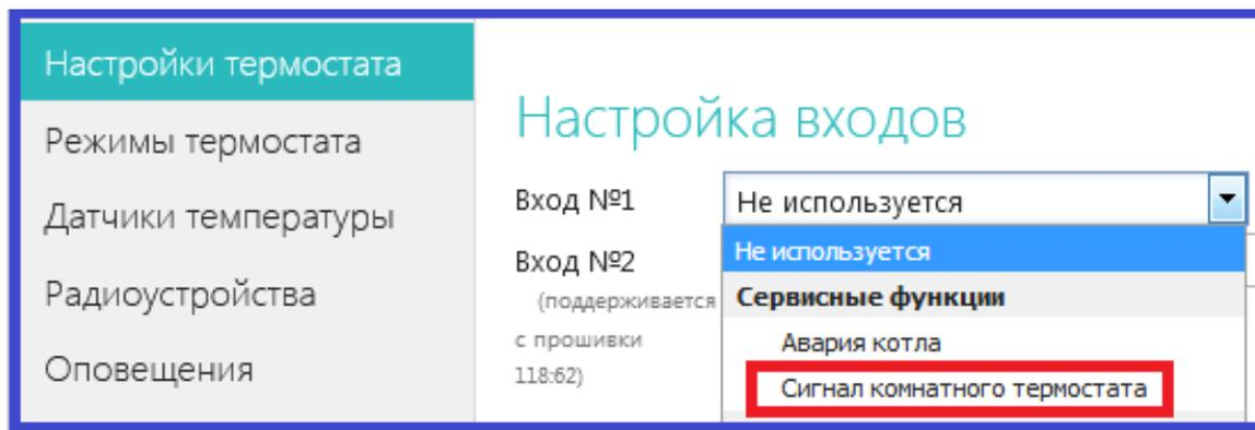
Переключение управления с дистанционного на ручной и обратно выполняется из мобильного приложения или через web-сервис. Для этого предназначен **Режим «Комнатный термостат»**.
