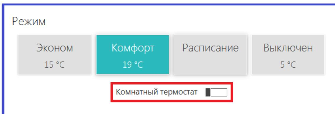
При включенном режиме «Комнатный термостат» управление работой котла выполняется по сигналам от комнатного терморегулятора.
