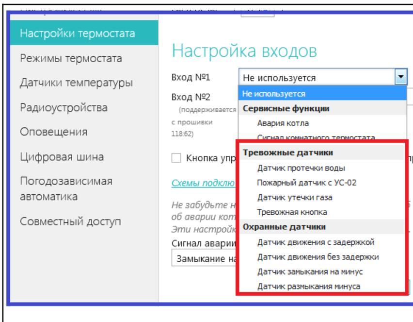
Для того, чтобы Вход, к которому подключен шлейф с датчиками, мог обрабатывать сигнал срабатывания любого из них, в Настройках термостата нужно обязательно указать тип сигнала, выбрав его из выпадающего списка.
