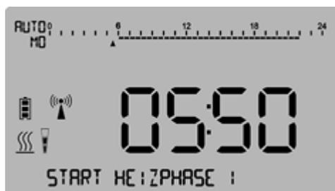
2. Подтвердите ввод, нажатием кнопки меню, а затем установите свою **KOMFORTTEMPERATUR** (КОМФОРТНУЮ ТЕМПЕРАТУРУ), которую "R-Tronic" должен обеспечить в помещении в HEIZPHASE 1 (ПЕРИОД ОТОПЛЕНИЯ 1):
