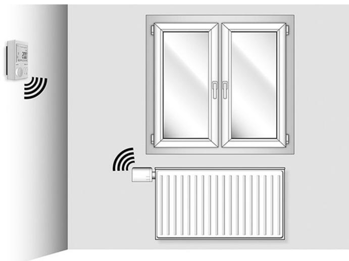
Сервопривод должен быть «связан» с беспроводным термостатом, для того, чтобы управление температурой в помещении осуществлялось в соответствии с заданным значением. Специальным термином „Anlernen“ («Установка связи») обозначается установление радиосвязи между двумя приборами.
