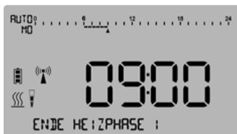
4. Теперь определите **ABSENKTEMPERATUR (ТЕМПЕРАТУРУ ПОНИЖЕНИЯ)** т.е. нижнее ограничение температуры помещения, с которой будет осуществляться отопление помещения **после завершения HEIZPHASE 1 (ПЕРИОДА ОТОПЛЕНИЯ 1)**. Эта настройка будет действовать до начала **HEIZPHASE 2 (ПЕРИОДА ОТОПЛЕНИЯ 2)**.
