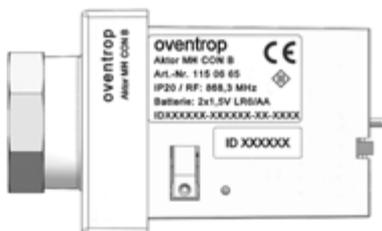
4. Вставьте новые батарейки. Маркировка +/- определяет правильность положения. Сигнальный светодиод однократно быстро мигает красным, а затем трижды медленно зеленым.
