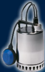
**Дренажный насос UNILIFT KP** предназначен для перекачивания чистой и загрязненной воды (в т. ч. горячей, до 70 °С в течение 2-х минут с интервалом не менее 30 мин.) без волокнистых включений с твердыми частицами размером до 10 мм. Способен откачивать воду до уровня 10 мм. Используется для отведения воды из затопливаемых помещений, дренажных приемков, бассейнов, рек, прудов, различных емкостей. Также используется для отведения воды от стиральных машин, моечных агрегатов и душа.
