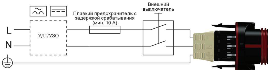
Рис. 12 Пример штекерного подключения с внешним выключателем, предохранителем и дополнительной защитой, 1 x 230 В ± 10 %, 50/60 Гц, защитное заземление
