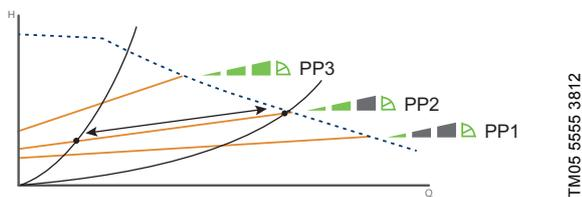
Рис. 17 Три кривые режима управления пропорционального изменения давления.
