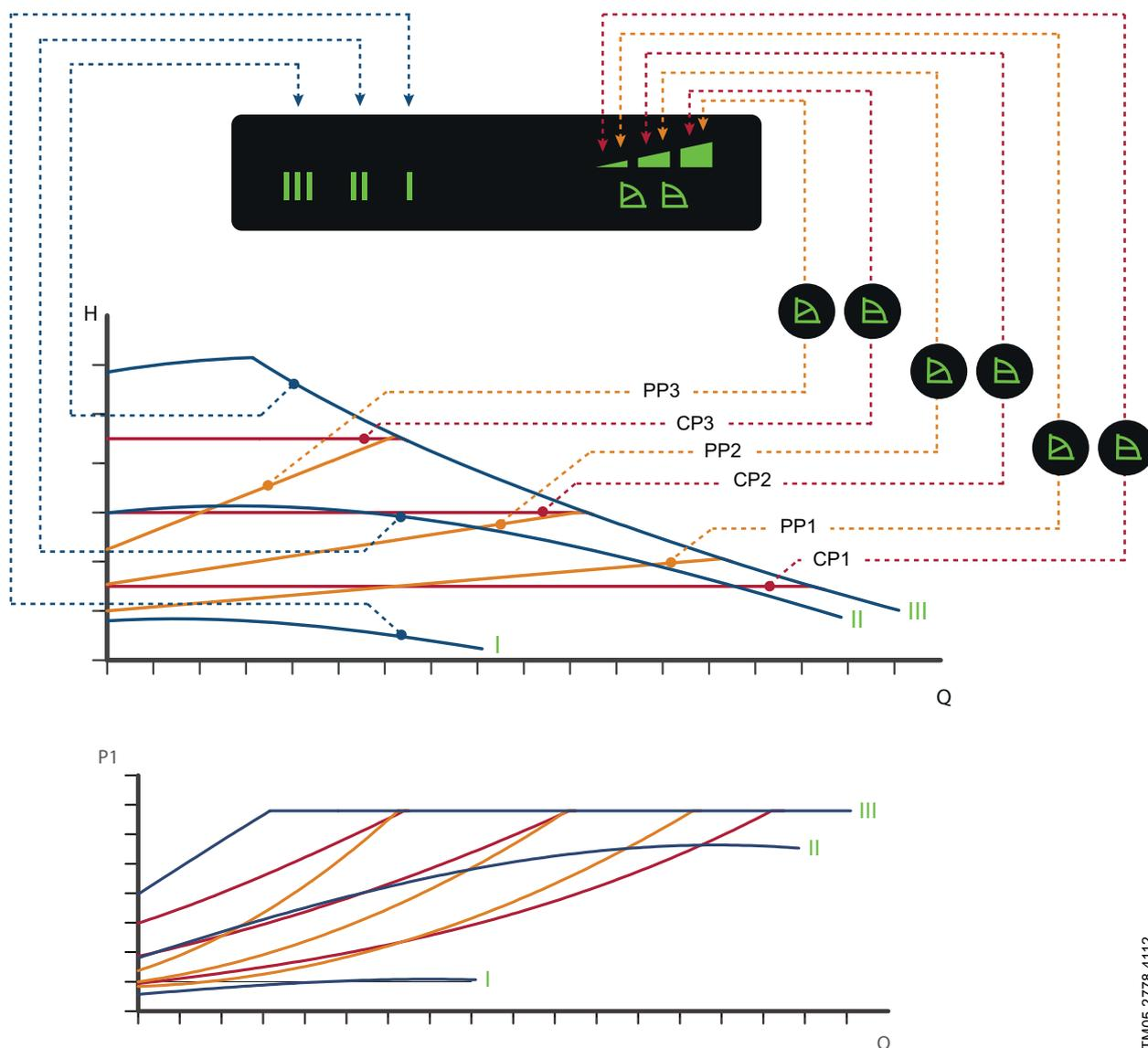
Рис. 23 Соотношение между режимами управления и энергопотреблением насоса
