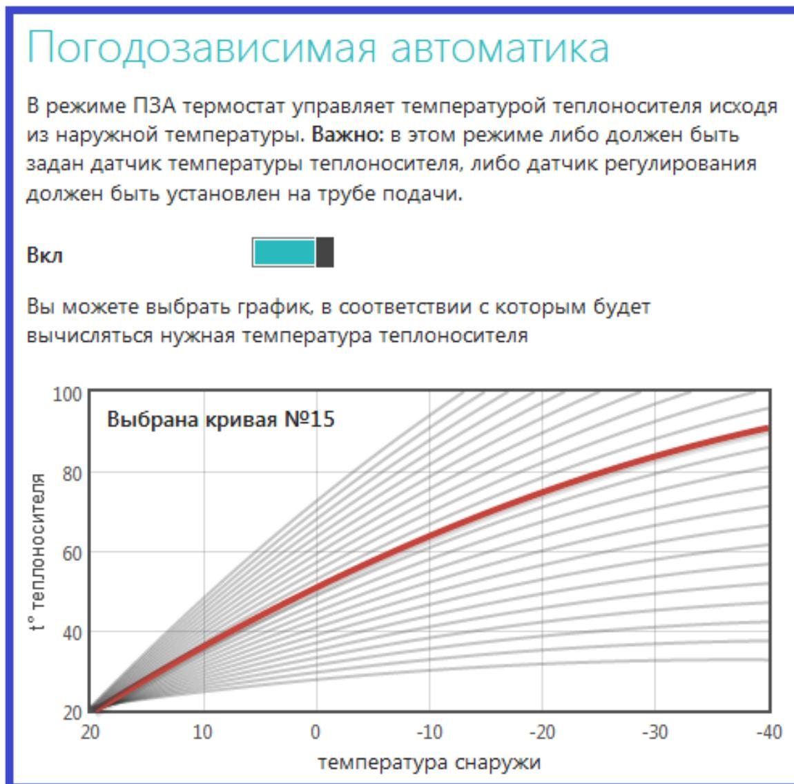
**Режим ПЗА** предназначен для управления любым контуром системы отопления с учетом изменения температуры на улице.
