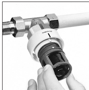
Рис. 13: Снять маховик. Держатель чувствительного элемента поворотом вправо до предела вкрутить в основании, затем выкрутить влево так, чтобы метка юстировки (отверстие или белый штрих) встала напротив указателя настройки.
