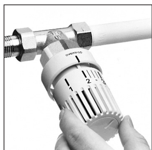
Рис. 11: Надеть маховик таким образом, чтобы цифра „2“ находилась напротив указателя настройки. Теперь настройка заблокирована на цифре „2“ (ок. 16 °С). Затем, надавить на маховик так, чтобы он вошел в держатель и зафиксировался.
