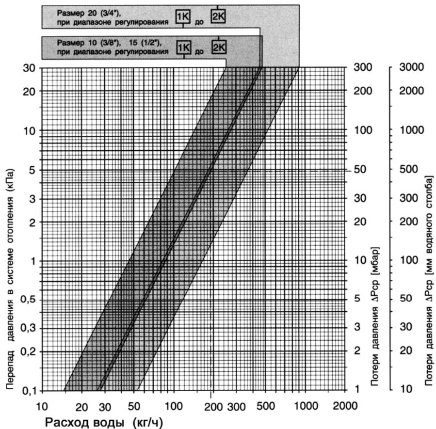
Рис. 2.4. Гидравлические характеристики термостатов «Super»
