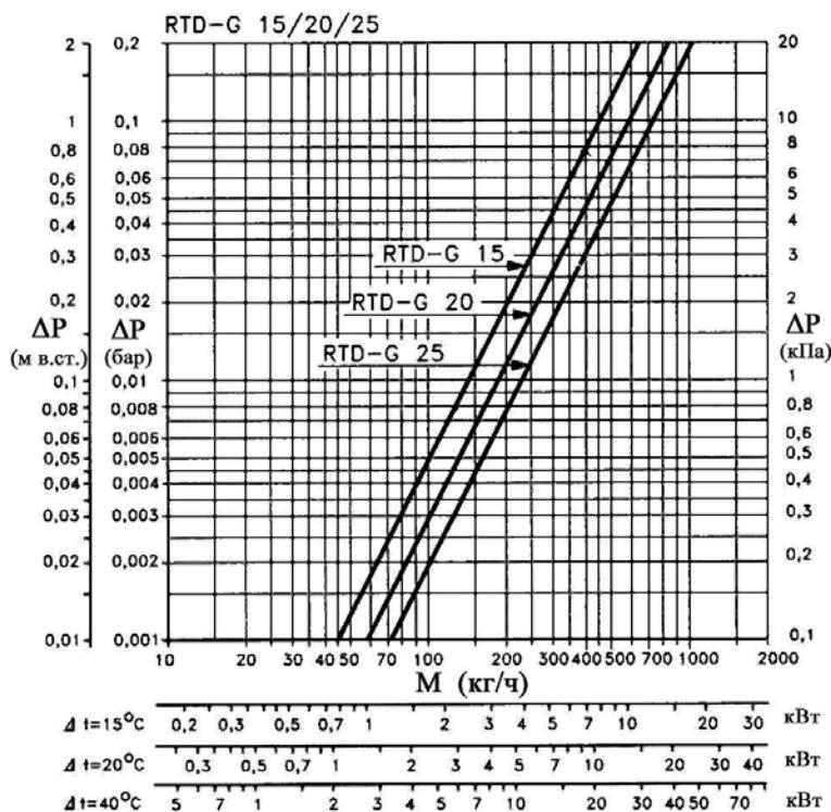
Рис. 2.2. Гидравлические характеристики термостатов «Данфосс»:
