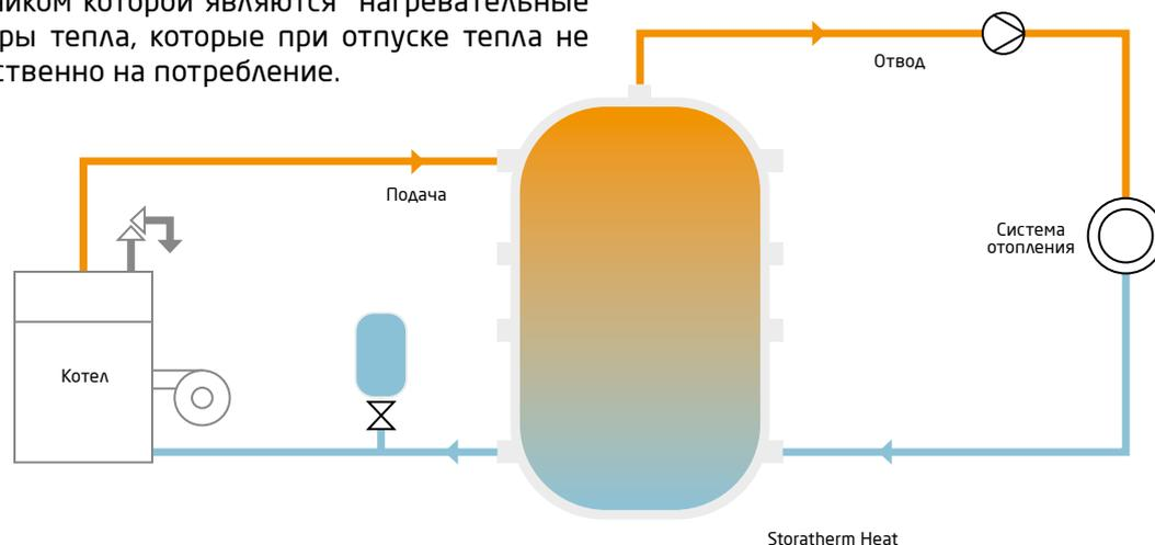
При работе нагревательного котла в накопитель сверху подается горячая вода. Котел отключается, когда температура воды на выходе равна температуре подаче. Независимо от времени вода из накопителя может использоваться в соответствии с нуждами потребителя.
