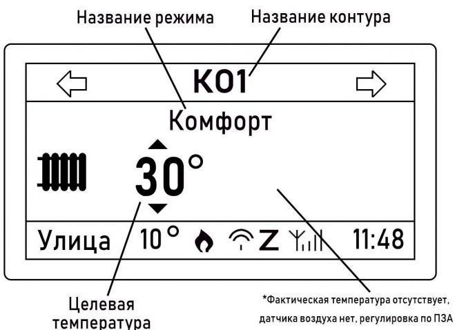
**Примечание:** При управлении по ПЗА, показания датчика температуры не отображаются.
