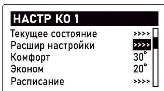
Прямые и смесительные контуры имеют схожие расширенные настройки, и отличаются только применяемым в них типом смещивания, который задается в настройке "Конфигурация системы"
