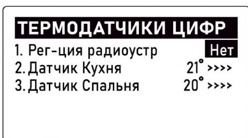
В строке “Регистрация радиоустройств” выбираем “Да”, нажимаем кнопку . После нажатия следует зарегистрировать радиодатчик (описание выше).
